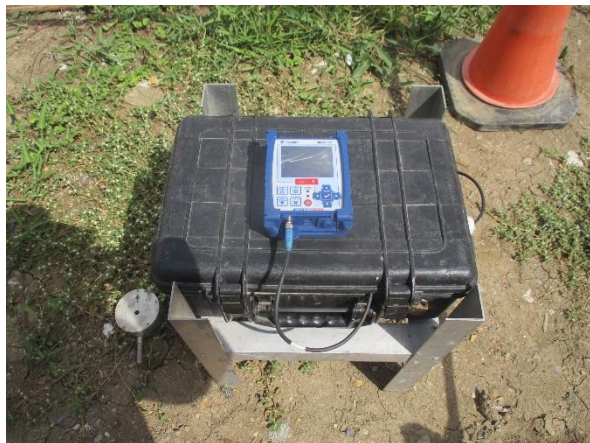
รูปที่ 2.1-33 การตรวจวัดแรงสั่นสะเทือนบริเวณพื้นที่โครงการและบ้านเลขที่ 39 ช่วงเดือนกรกฎาคม 2566
