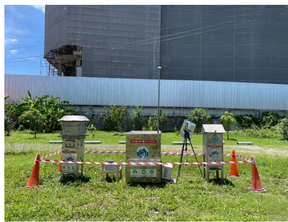
รูปที่ 2.1-31 การตรวจวัดปริมาณฝุ่นละอองรวม (TSP) และ PM-10 บริเวณพื้นที่โครงการและบ้านเลขที่ 39 ช่วงเดือนกรกฎาคม 2566
