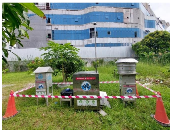
รูปที่ 2.1-43 การตรวจวัดปริมาณฝุ่นละอองรวม (TSP) และ PM-10 บริเวณพื้นที่โครงการและบ้านเลขที่ 39 ช่วงเดือนพฤศจิกายน 2566
