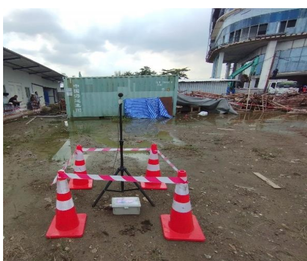
รูปที่ 2.1-38 การตรวจวัดระดับเสียง บริเวณพื้นที่โครงการและบ้านเลขที่ 39 ช่วงเดือนกันยายน 2566
